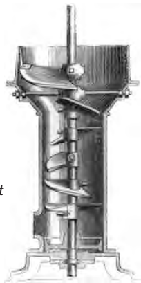
Ziegelpresse: Die Erfindung der kontinuierlich arbeitenden Ziegelpresse im Jahr 1854 markiert den Beginn der maschinellen Ziegelproduktion.
