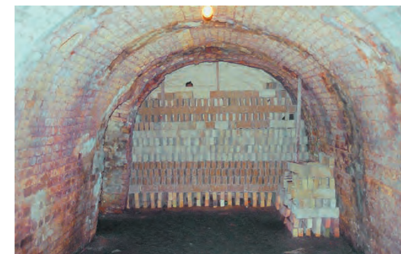
In der Brennkammer eines Ringofens Ziegeleimuseum Cathrinesminde
